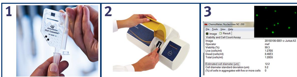
Abb. 12: 3-stufige Prozedur des NucleoCounters
